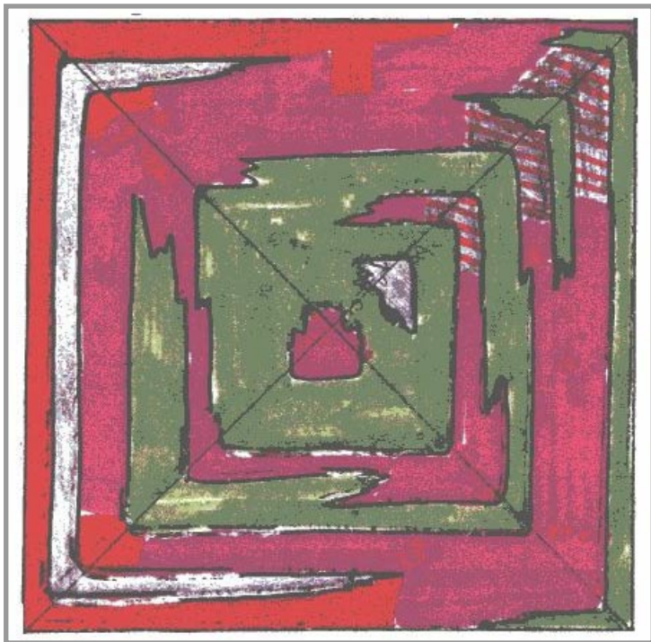
Figure 8 Anomalies détectées lors des mesures de microgravimétrie effectuées sous l'égide d'EDF en 1986/87. En rouge, les zones de forte densité correspondant à celles des pierres utilisées pour la construction de la pyramide. En vert, les zones de faible densité pouvant indiquer la présence de vide dans la construction
